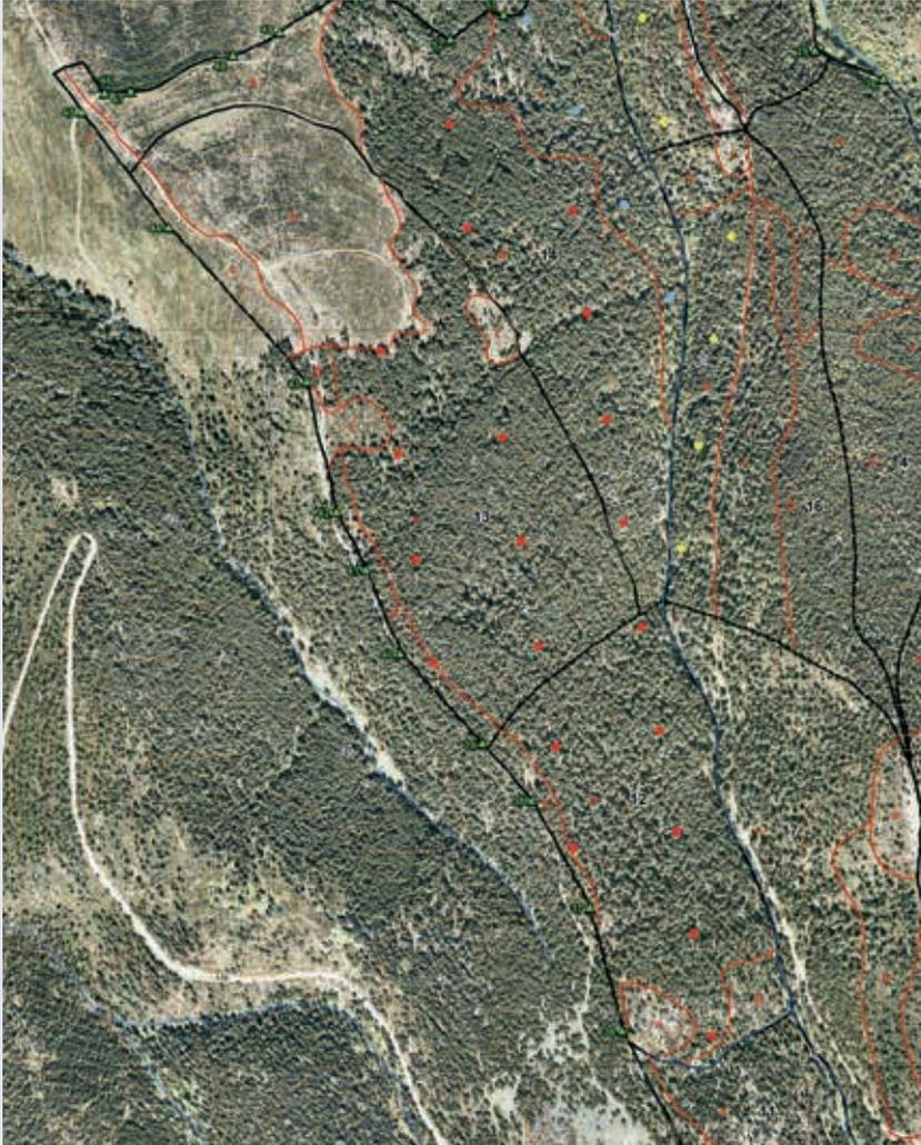
**Figura 53:** Ejemplo de distribución sistemática de parcelas para el inventario en una ordenación por rodales. El color de las parcelas indica una misma unidad de inventario, que puede ser un grupo de varios rodales similares o un solo rodal. Ortofotomapa a color año 2003 y base topográfica 1:5000 del Institut Cartogràfic de Catalunya.
